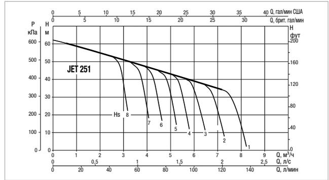
Кривые рабочих характеристик зависят от значений кинематической вязкости = 1 мм²/с и плотности, эквивалентной 1000 кг/м³. Допуск кривой соответствует ISO 9906.
