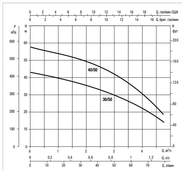
Кривые рабочих характеристик зависят от значений кинематической вязкости = 1 мм<sup>2</sup>/с и плотности, эквивалентной 1000 кг/м<sup>3</sup>. Допуск кривой соответствует ISO 9906.
