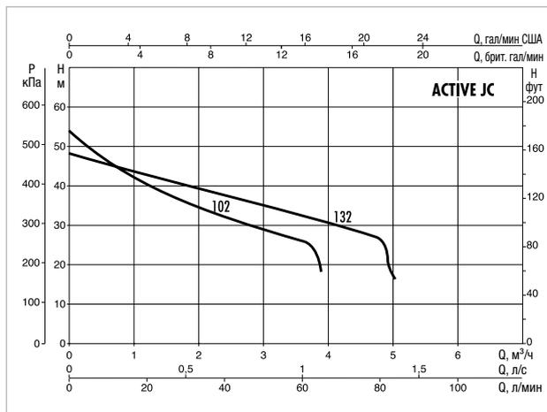
Кривые рабочих характеристик зависят от значений кинематической вязкости = 1 мм<sup>2</sup>/с и плотности, эквивалентной 1000 кг/м<sup>3</sup>. Допуск кривой соответствует ISO 9906.
