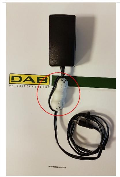
*Рисунок 11 - Положение ферритового сердечника*
