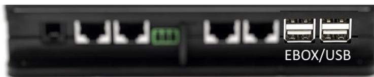
Рисунок 6 - USB-разъем на панели EBox и в DConnect Vox
