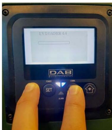
Рисунок 9D – Доступ к Loader для обновления e.sybox mini3 По 1.X
