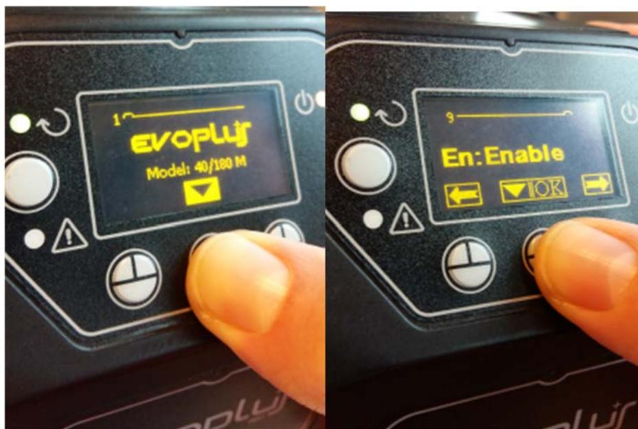
Рис. 10 - Конфигурация ПО многофункционального модуля
