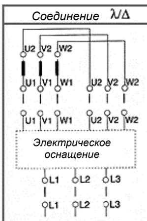
Двигатели с 6 проводами могут быть запущены с пусковым механизмом звезда / треугольник только в том случае, если напряжение в сети соответствует минимальному напряжению, указанному на паспортной табличке двигателя.
