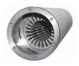
Восстанавливаемый статор зашишен кожухом из нержавеющей стали марки AISI 316. В стандартном исполнении ротор обмотан проволокой, покрытой ПВХ (РЕ2+РА для 300 л. с. и 340 л. с.). По запросу может быть поставлена версия с обмоткой РЕ2+РА, которая обеспечивает возможность использования электродвигателя в особых ситуациях, с частотнорегулируемым приводом.
