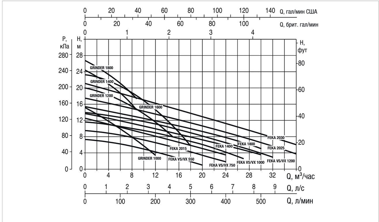
Кривые производительности рассчитываются на основе значений коэффициента кинематической вязкости = 1 мм²/сек и плотности = 1000 кг/м³. Погрешность кривых согласно ISO 9906.
