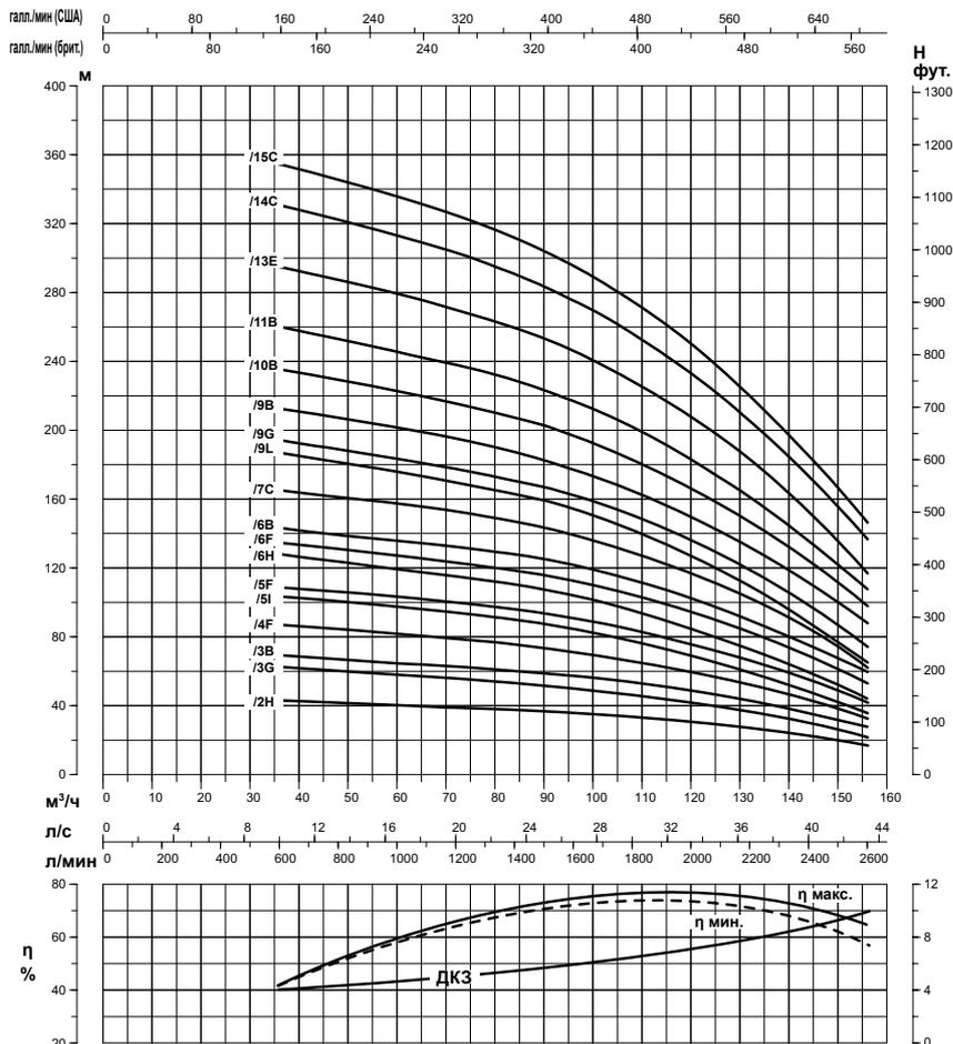
Эксплуатационные характеристики, 50 Гц, 2 полюса. Кривые производительности рассчитываются на основе значений коэффициента кинематической вязкости, равного 1 мм²/с, и плотности, равной 1000 кг/м³. Погрешность кривых согласно ISO 9906.
