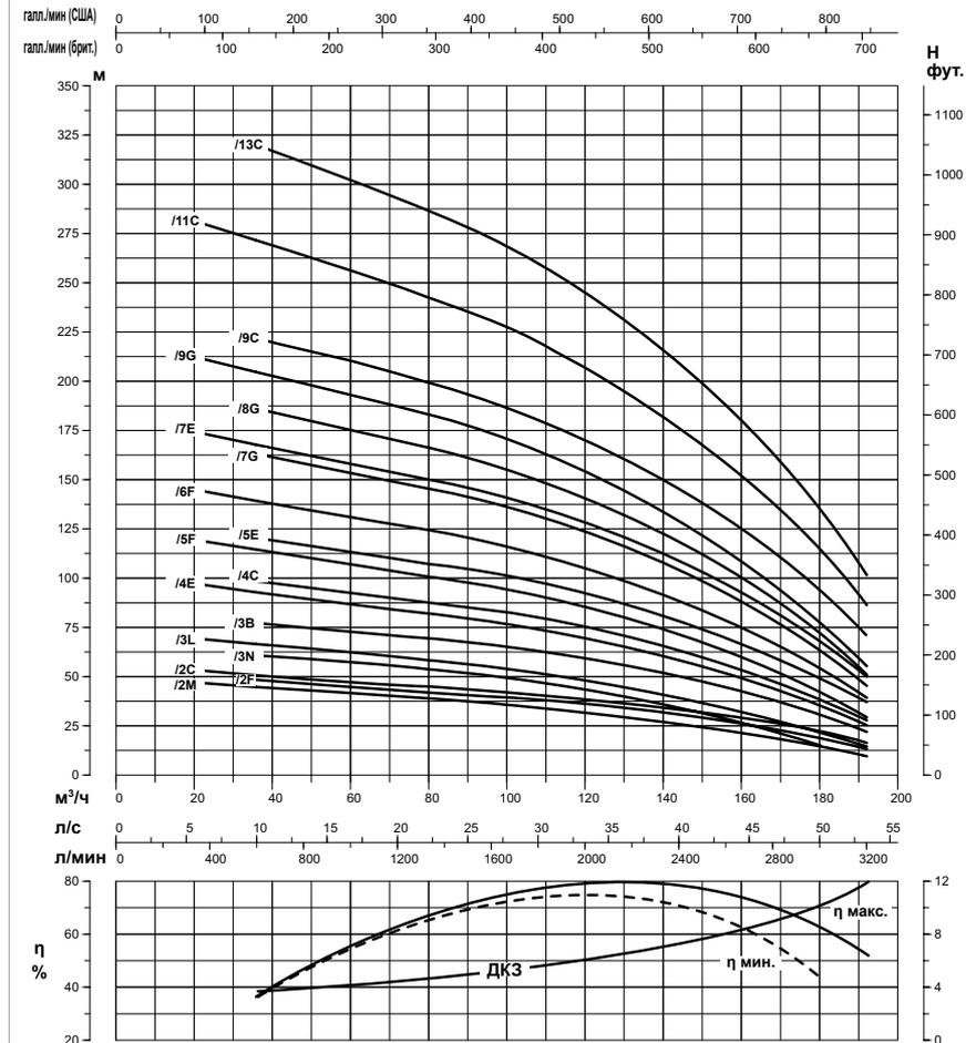
Эксплуатационные характеристики, 50 Гц, 2 полюса. Кривые производительности рассчитываются на основе значений коэффициента кинематической вязкости, равного 1 мм²/с, и плотности, равной 1000 кг/м³. Погрешность кривых согласно ISO 9906.
