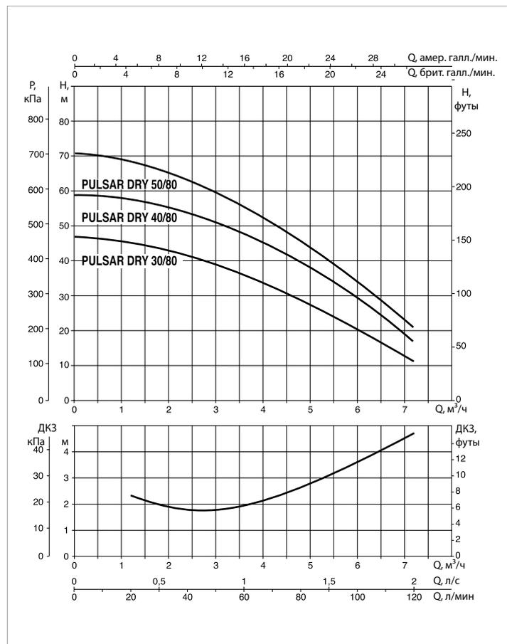
Кривые производительности рассчитываются на основании значений коэффициента кинематической вязкости, равного 1 мм²/с, и плотности, равной 1000 кг/м³. Погрешность кривых согласно ISO 9906.
