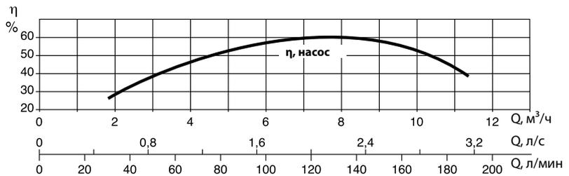
Эксплуатационные характеристики, 50 Гц, 2 полюса. Кривые производительности рассчитываются на основе значений коэффициента кинематической вязкости, равного 1 мм²/с, и плотности, равной 1000 кг/м³. Погрешность кривых согласно ISO 9906.
