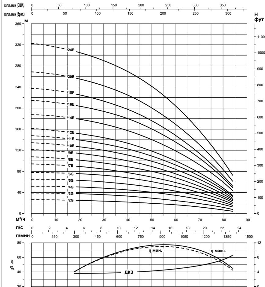
Эксплуатационные характеристики, 50 Гц, 2 полюса. Кривые производительности рассчитываются на основе значений коэффициента кинематической вязкости, равного 1 мм²/с, и плотности, равной 1000 кг/м³. Погрешность кривых согласно ISO 9906. Соответствие МИЭ
