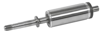
Валы с концевой муфтой изготовлены из дуплексной нержавеющей стали/марки AISI 304 со специальной закалкой поверхности и полировкой рабочей области вкладышей. Короткозамкнутый ротор изготавливается из алюминия для показателей мощности до 3 л. с. и углеродистой стали для электродвигателей мощностью свыше 4 л. с.
