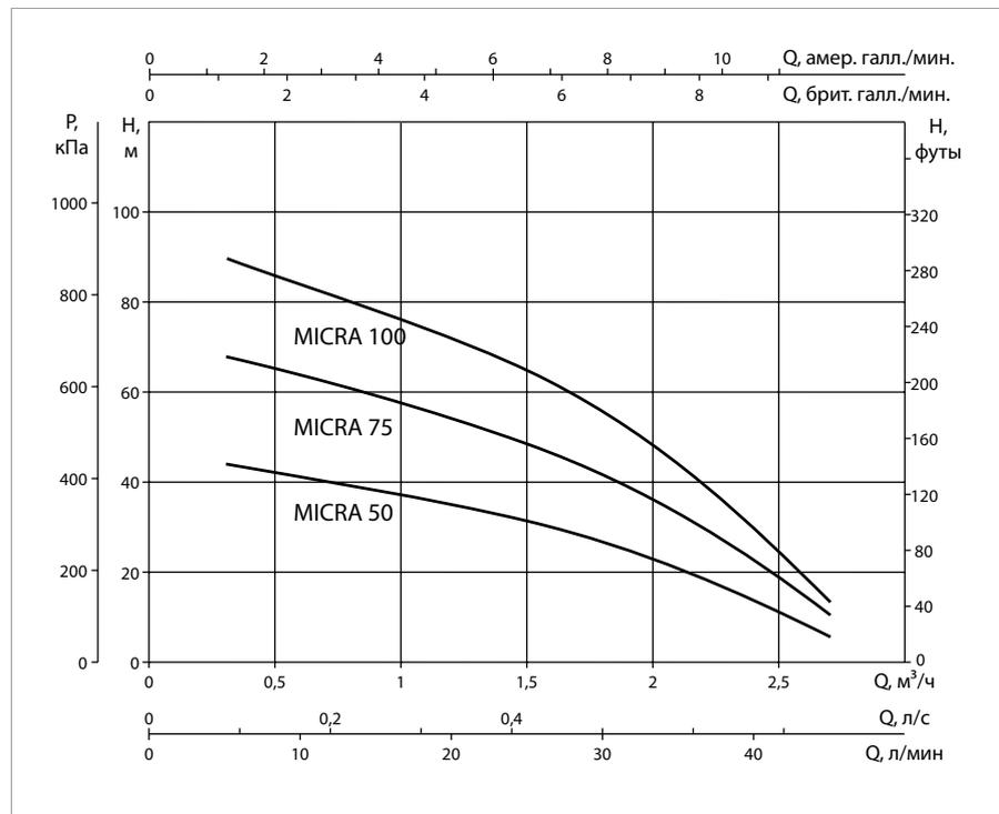
Кривые производительности рассчитываются на основании значений коэффициента кинематической вязкости = 1 мм²/с и плотности, эквивалентной 1000 кг/м³. Погрешность кривых согласно ISO 9906.
