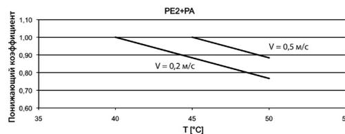
Для TR8 110 кВт максимальная температура жидкости на 5 °С ниже указанной на графиках.
