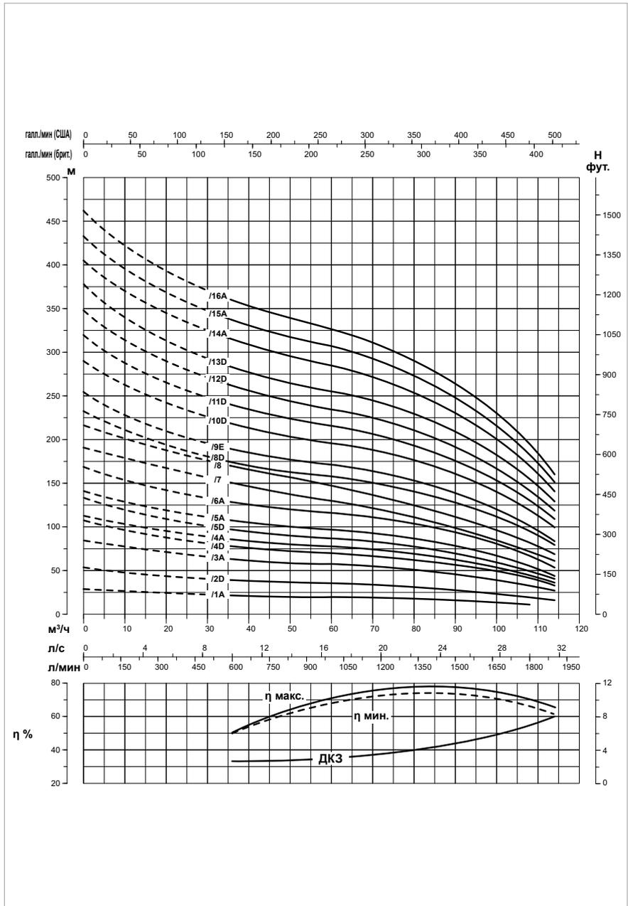
Эксплуатационные характеристики, 50 Гц, 2 полюса. Кривые производительности рассчитываются на основе значений коэффициента кинематической вязкости, равного 1 мм<sup>2</sup>/с, и плотности, равной 1000 кг/м<sup>3</sup>. Погрешность кривых согласно ISO 9906.
