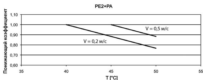
Для TR12 220 кВт PE2+PA и 250 кВт PE2+PA 50 Гц и для всех моделей TR12 60 Гц максимальная температура жидкости на 10 °С ниже указанной на графике. Для TR12 300 кВт PE2+PA максимальная температура жидкости составляет 25°С.
