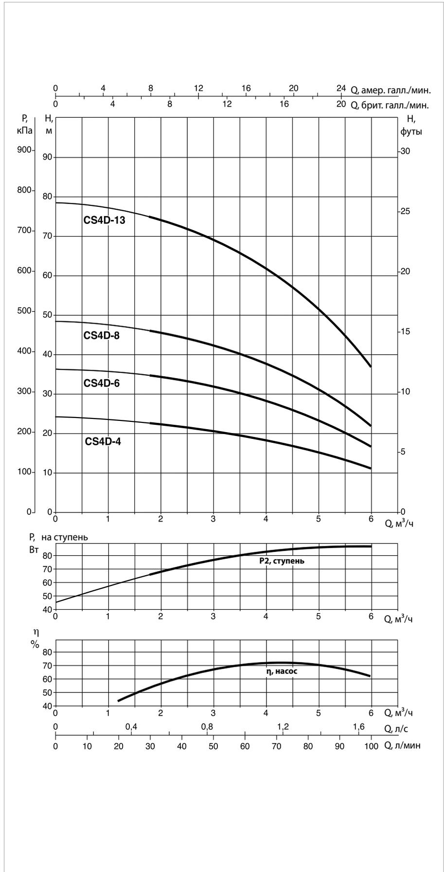
Эксплуатационные характеристики, 50 Гц, 2 полюса. Кривые производительности рассчитываются на основе значений коэффициента кинематической вязкости, равного 1 мм<sup>2</sup>/с, и плотности, равной 1000 кг/м<sup>3</sup>. Погрешность кривых согласно ISO 9906.
