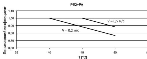
Для TR10 170 кВт PE2+PA максимальная температура жидкости на 5 °С ниже указанной на графиках. Для TR10 190 кВт PE2+PA она на 10 °С ниже.
