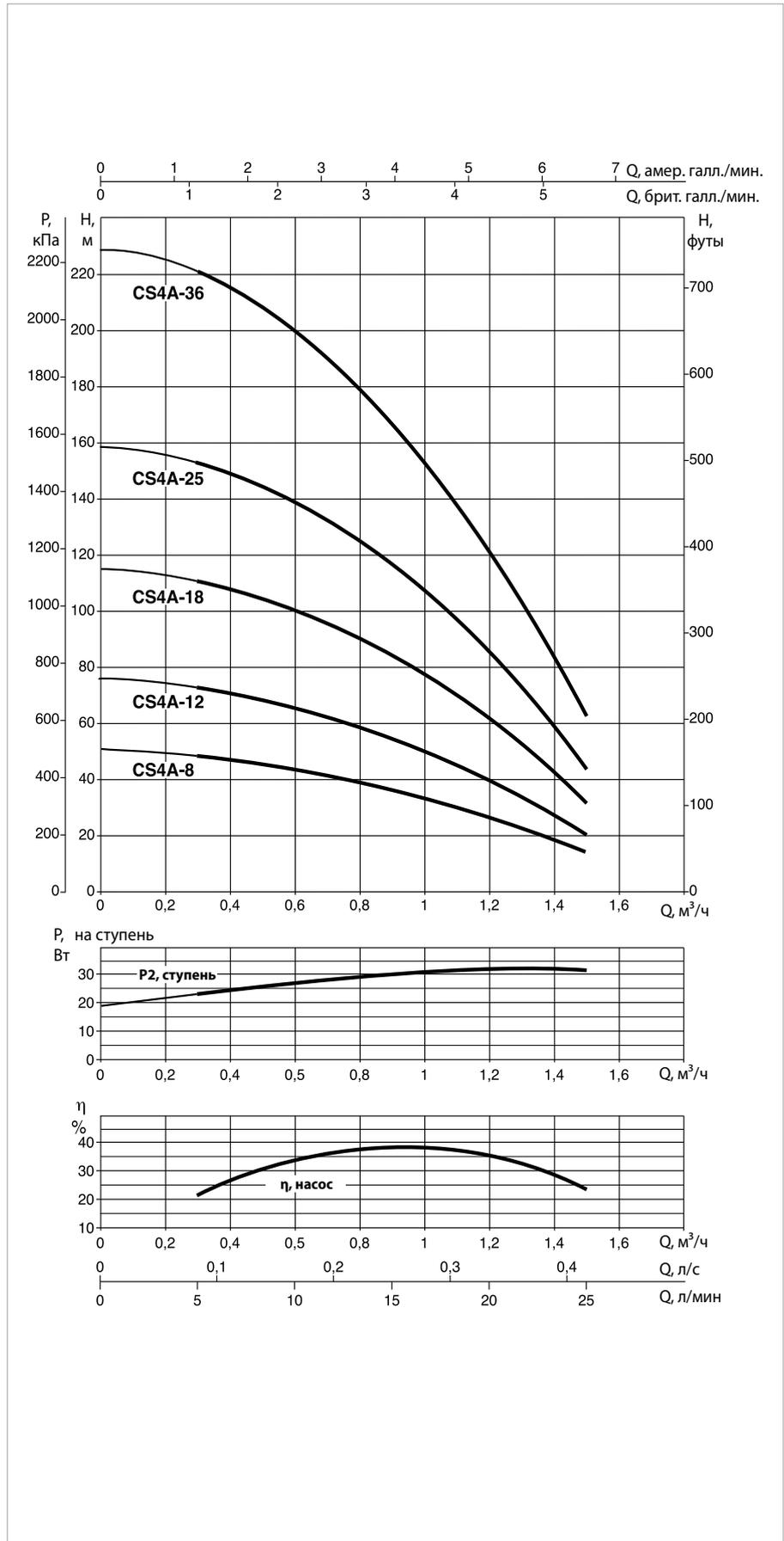
Эксплуатационные характеристики, 50 Гц, 2 полюса. Кривые производительности рассчитываются на основе значений коэффициента кинематической вязкости, равного 1 мм²/с, и плотности, равной 1000 кг/м³. Погрешность кривых согласно ISO 9906.
