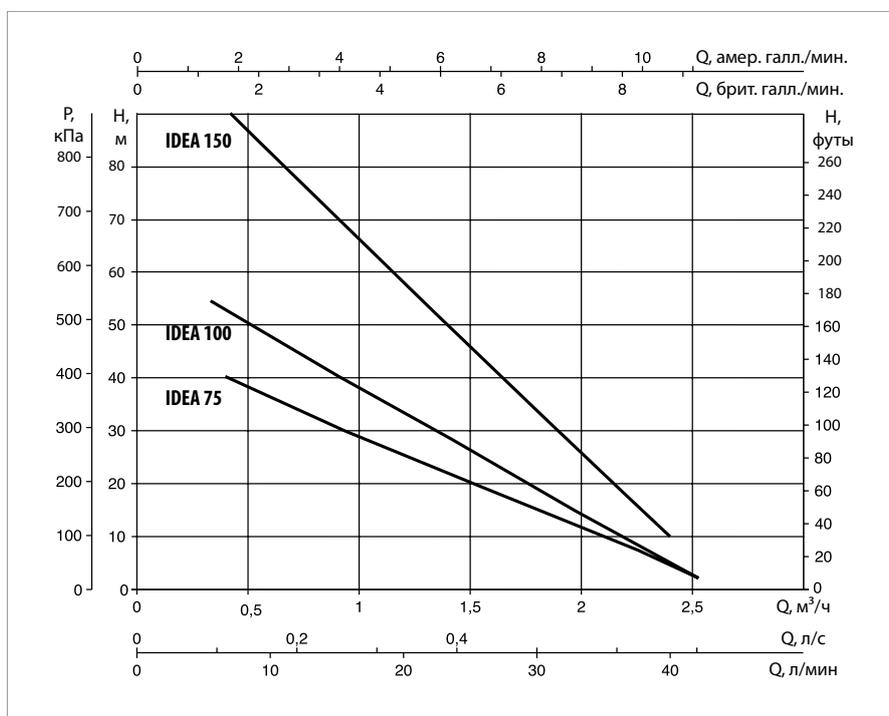
Кривые производительности рассчитываются на основании значений коэффициента кинематической вязкости, равного 1 мм²/с, и плотности, равной 1000 кг/м³. Погрешность кривых согласно ISO 9906.
