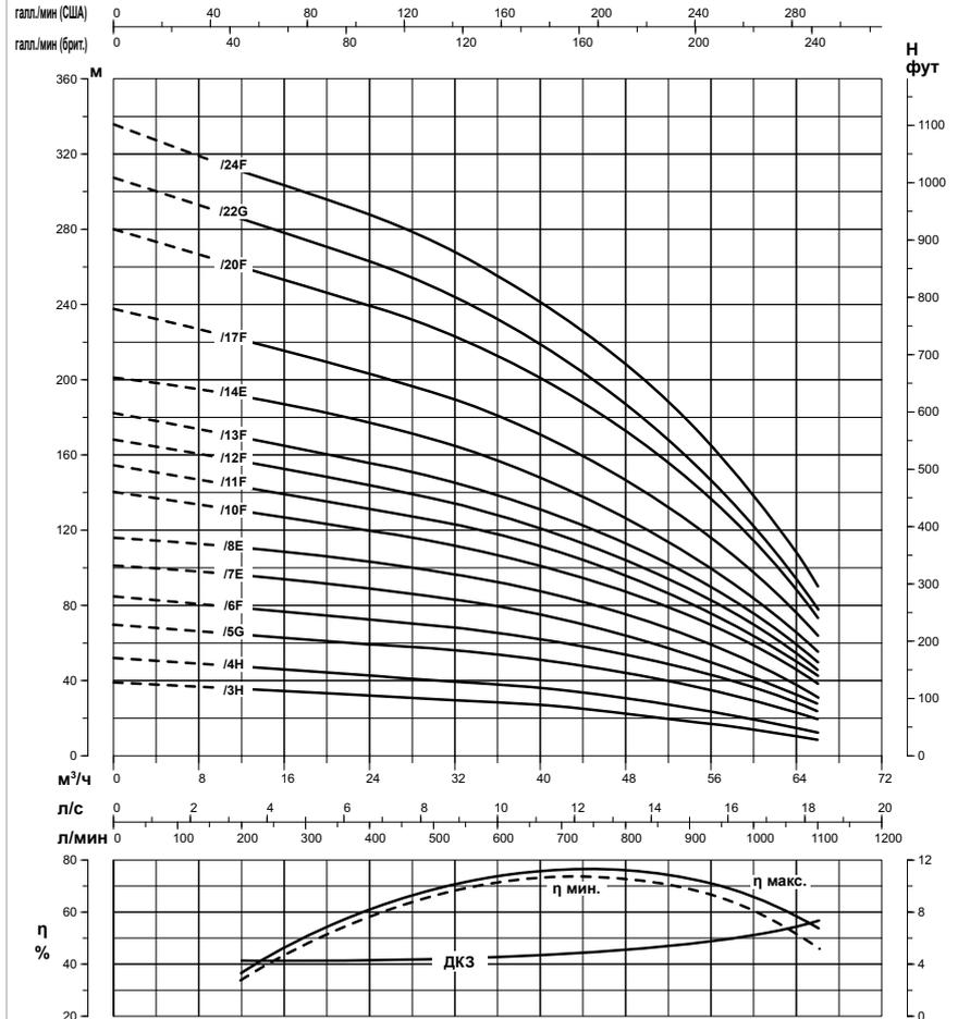
Эксплуатационные характеристики, 50 Гц, 2 полюса. Кривые производительности рассчитываются на основе значений коэффициента кинематической вязкости, равного 1 мм²/с, и плотности, равной 1000 кг/м³. Погрешность кривых согласно ISO 9906. Соответствие МИЭ
