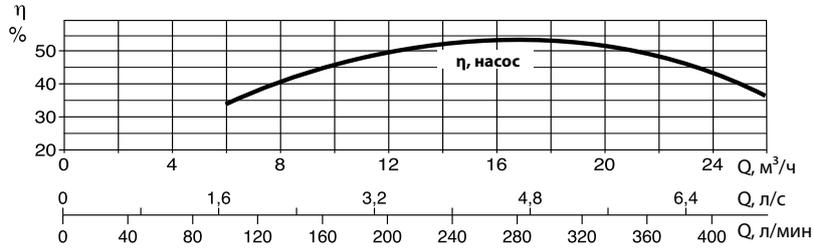
Эксплуатационные характеристики, 50 Гц, 2 полюса. Кривые производительности рассчитываются на основе значений коэффициента кинематической вязкости, равного 1 мм<sup>2</sup>/с, и плотности, равной 1000 кг/м<sup>3</sup>. Погрешность кривых согласно ISO 9906.
