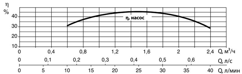
Эксплуатационные характеристики, 50 Гц, 2 полюса. Кривые производительности рассчитываются на основе значений коэффициента кинематической вязкости, равного 1 мм²/с, и плотности, равной 1000 кг/м³. Погрешность кривых согласно ISO 9906.
