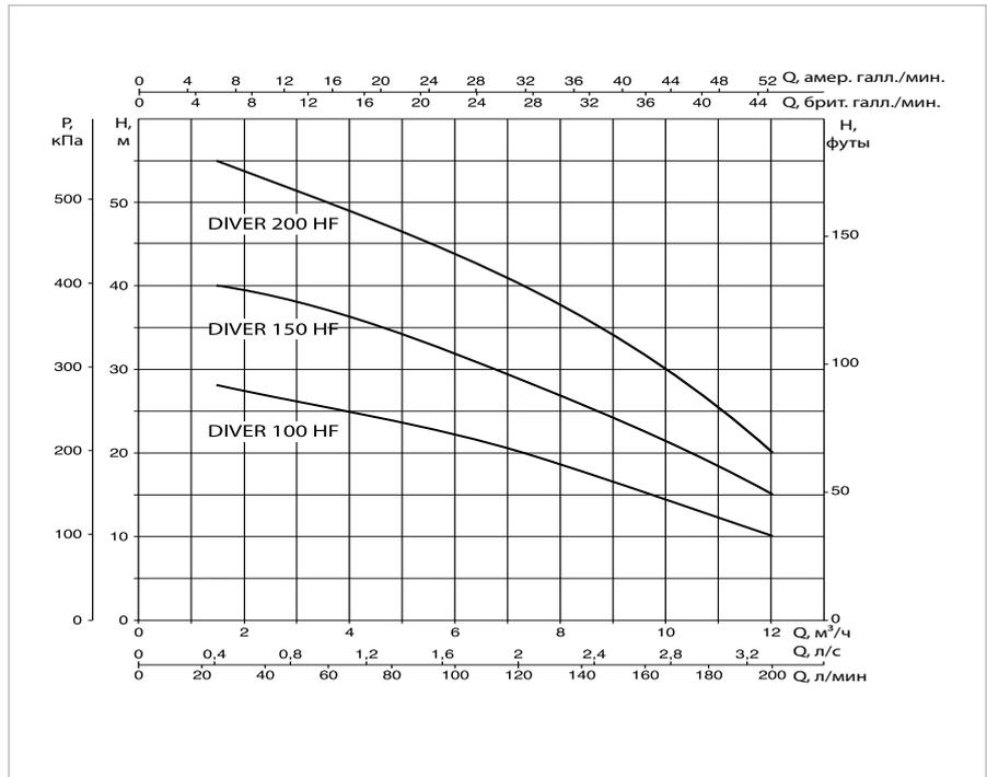
Кривые производительности рассчитываются на основании значений коэффициента кинематической вязкости, равного 1 мм²/с, и плотности, равной 1000 кг/м³. Погрешность кривых согласно ISO 9906.
