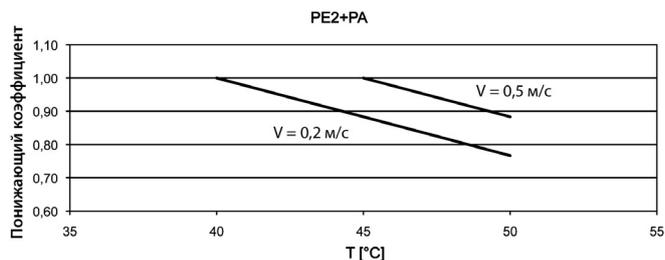
Для TR14 220 кВт PE2+PA и 250 кВт PE2+PA 50 Гц и для всех моделей TR14 60 Гц максимальная температура жидкости на 10 °С ниже, чем указано в графике.
