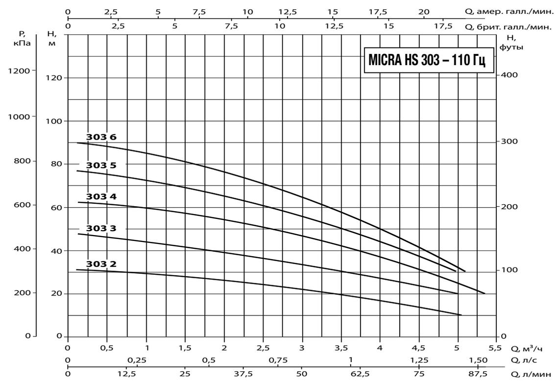
Кривые производительности рассчитываются на основании значений коэффициента кинематической вязкости, равного 1 мм<sup>2</sup>/с, и плотности, равной 1000 кг/м<sup>3</sup>.
