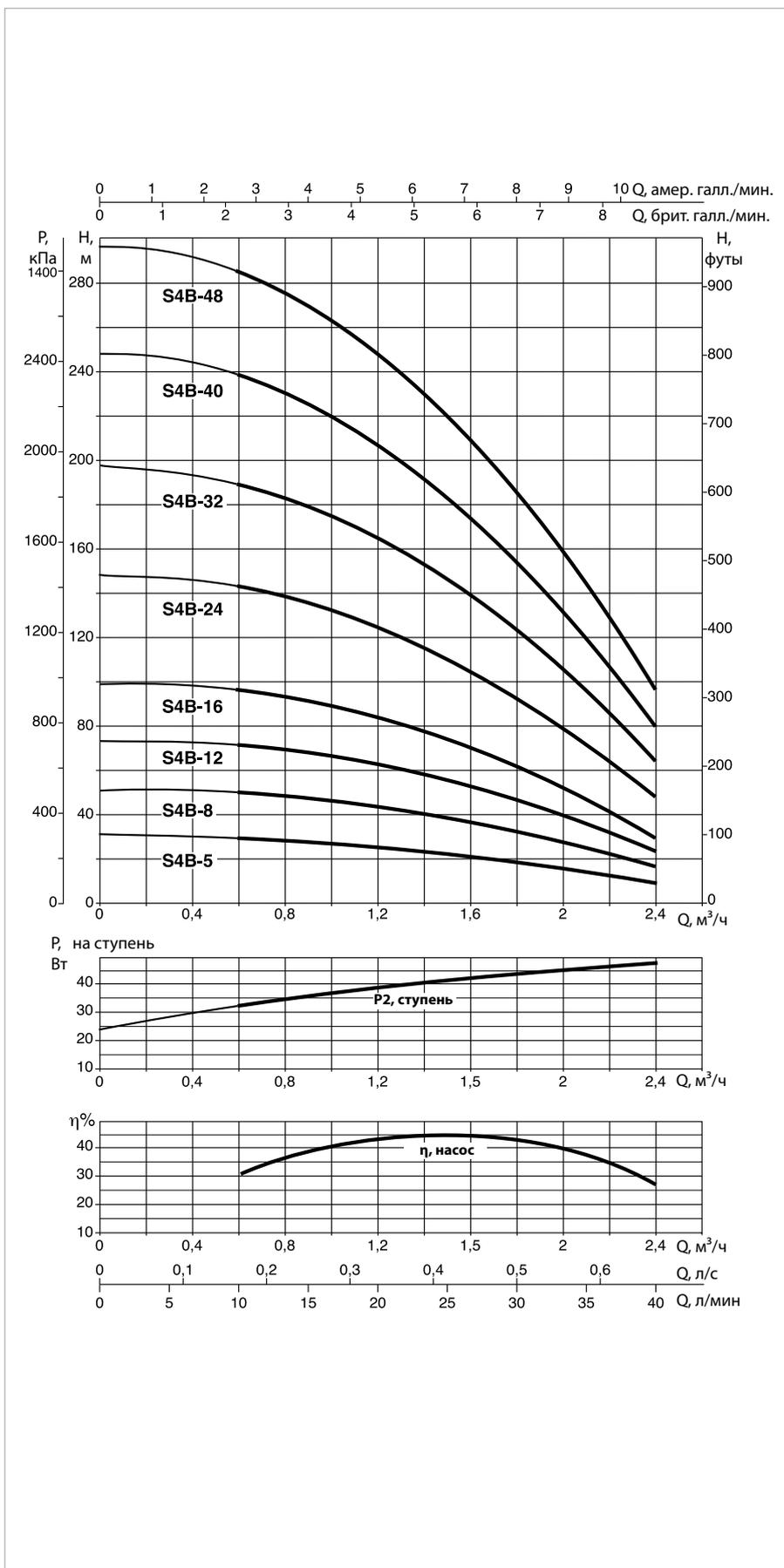
Эксплуатационные характеристики, 50 Гц, 2 полюса. Кривые производительности рассчитываются на основе значений коэффициента кинематической вязкости, равного 1 мм²/с, и плотности, равной 1000 кг/м³. Погрешность кривых согласно ISO 9906.
