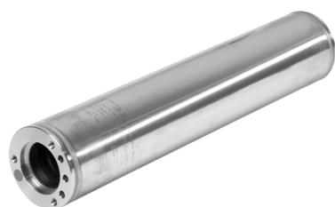
Статор установлен во внешний кожух, изготовленный из нержавеющей стали марки AISI 304. В статоре 18 отверстий для обеспечения лучшей эластичности и плавной работы; медные проводники имеют двойной слой изоляционной эмали класса H. Включена защита от перегрузки (однофазная модель).
