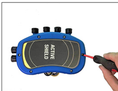
Рисунок 1: Снятие крышки Active Shield
