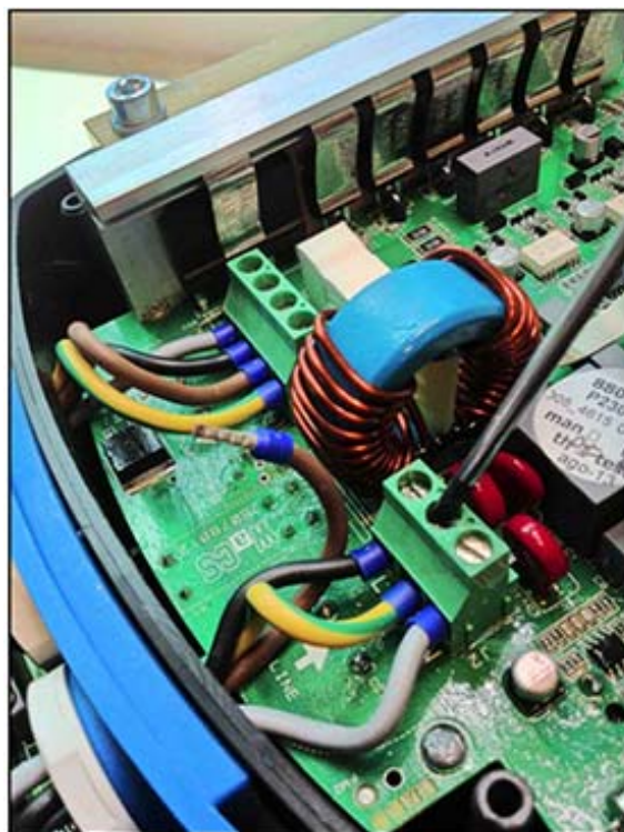
Figura 10: Collegamenti elettrici inverter
